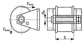
Die Umlenkrolle lenkt das Seil um 90° um. Die maximale Seilkraft beträgt  $F_{Smax}$  = 40 kN.
