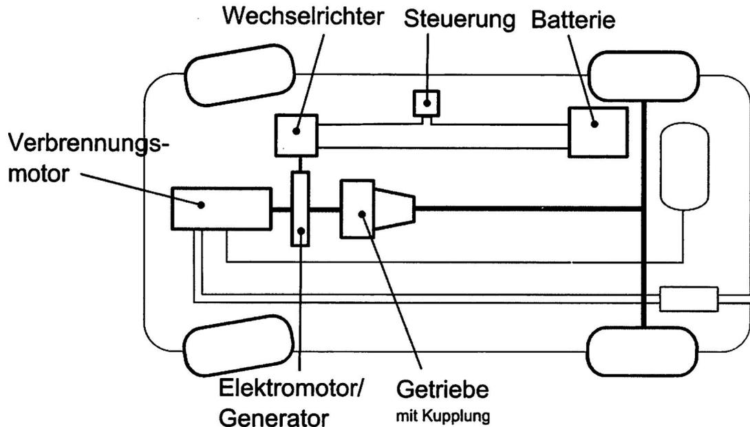
Im Hybridfahrzeug sind ein Elektromotor und ein Verbrennungsmotor kombiniert. Der Elektromotor unterstützt den Verbrennungsmotor beim Beschleunigen, so muss der Verbrennungsmotor weniger Energie aufbringen, wodurch der Benzinverbrauch sinkt. Beim Bremsen fungiert der Elektromotor als Generator, wodurch bei jedem Bremsvorgang die Batterien aufgeladen werden. Beim Laden und Entladen der Batterie sorgt der Wechselrichter für die erforderliche Gleich- bzw. Wechselspannung.
